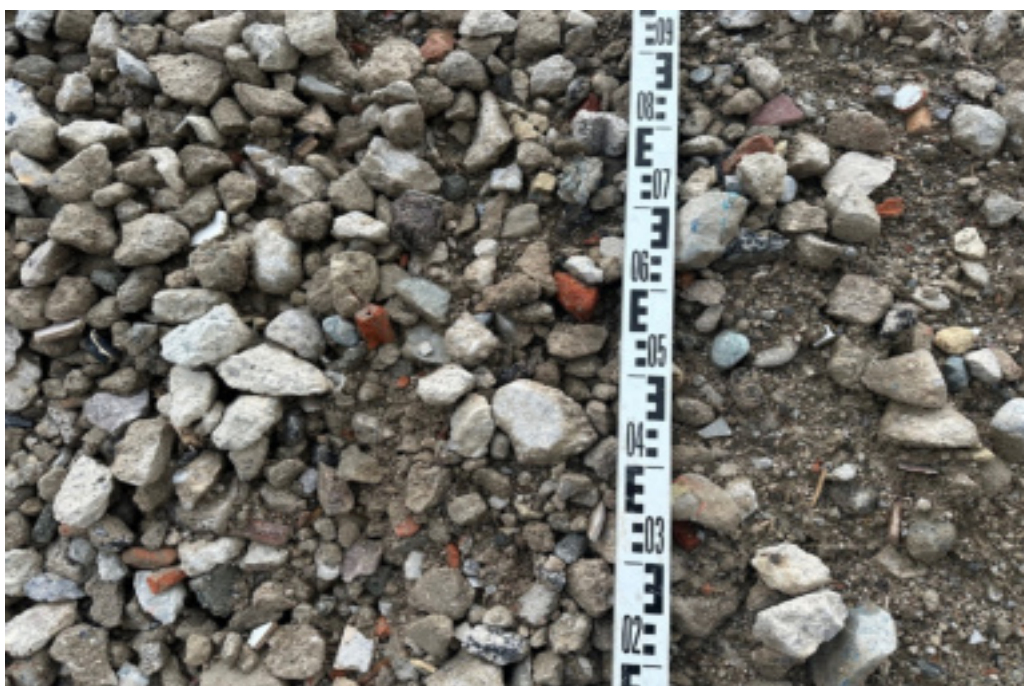
Foto 2: Detailaufnahme der recycelten Gesteinskörnung
